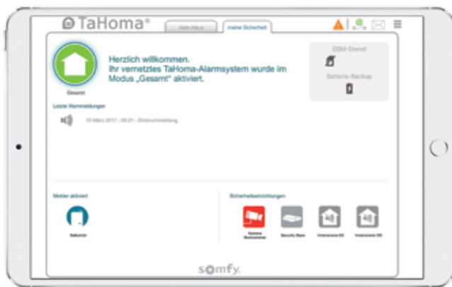
Übersicht über den aktiven Sicherheitsmodus, die letzten Alarme und die aktiven Sensoren.
