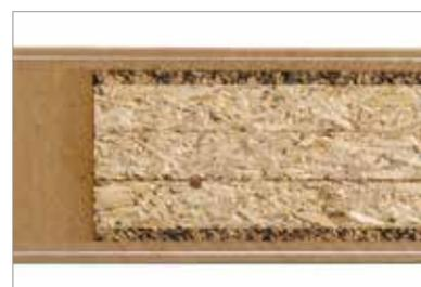
Schalldämmung durch mehrlagigen Aufbau.
